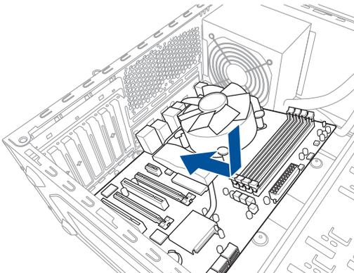
3. Setzen Sie die neun Schrauben in die durch Kreise markierten Bohrlöcher ein, um das Motherboard im Gehäuse zu befestigen.
